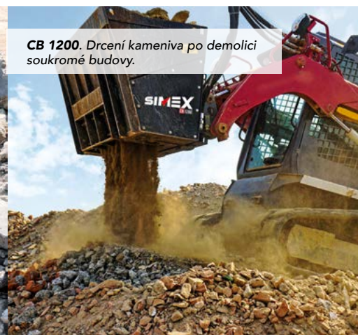
CB 1500. Zmenšení objemu smíšeného materiálu z demolice pro opětovné použití na stavbě.
